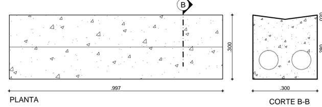
**D3 BORDILLO PREFABRICADO EN CONCRETO**
