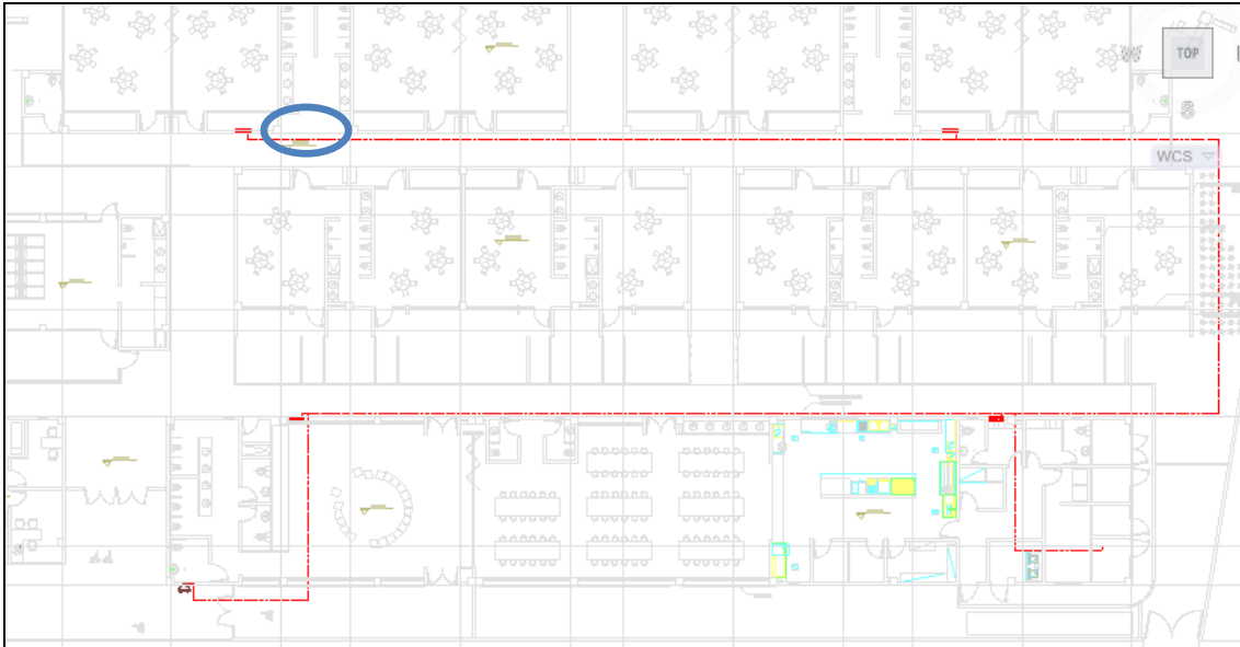
Figura 13. Esquema general Red Contra Incendio
