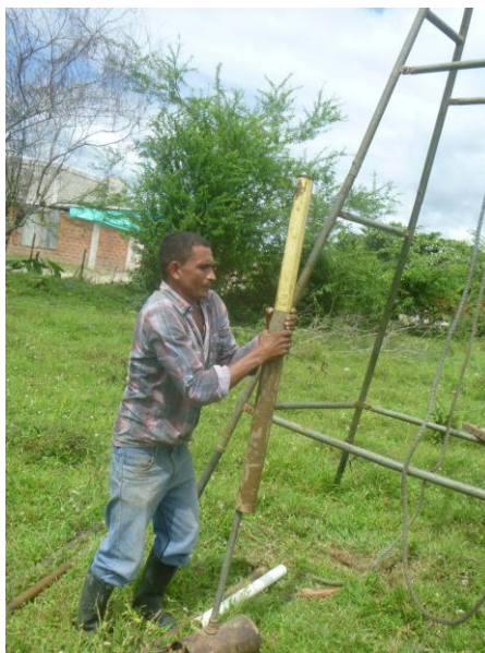
Ilustración 1. Procesos de muestreo ( S.P.T) para extracción de muestras para ensayos geotécnicos.
