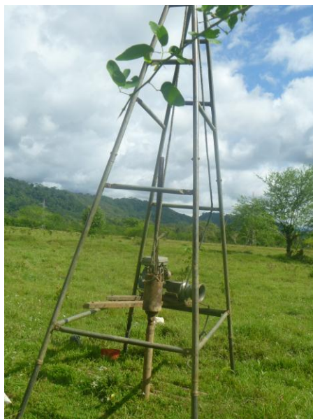
Ilustración 1. Procesos de muestreo ( S.P.T) para extracción de muestras para ensayos geotécnicos.
