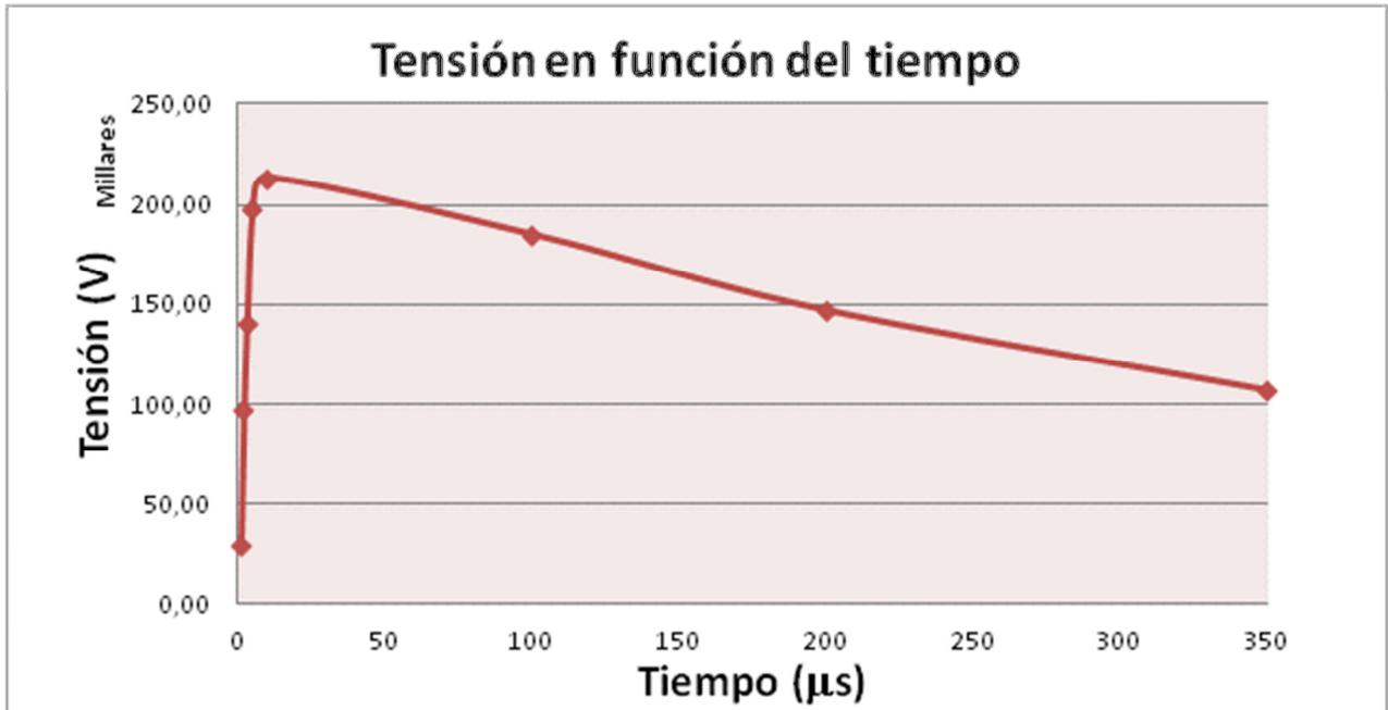
Figura 9 Tensión en el nodo de inyección de corriente de falla tipo rayo, para un electrodo tipo varilla de 2,4 m con contrapeso de 5 m.
