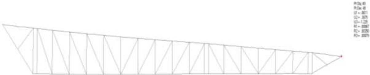
FIGURA 10 DEFLEXIONES EXTREMO DERECHO CERCHA TIPO 1
