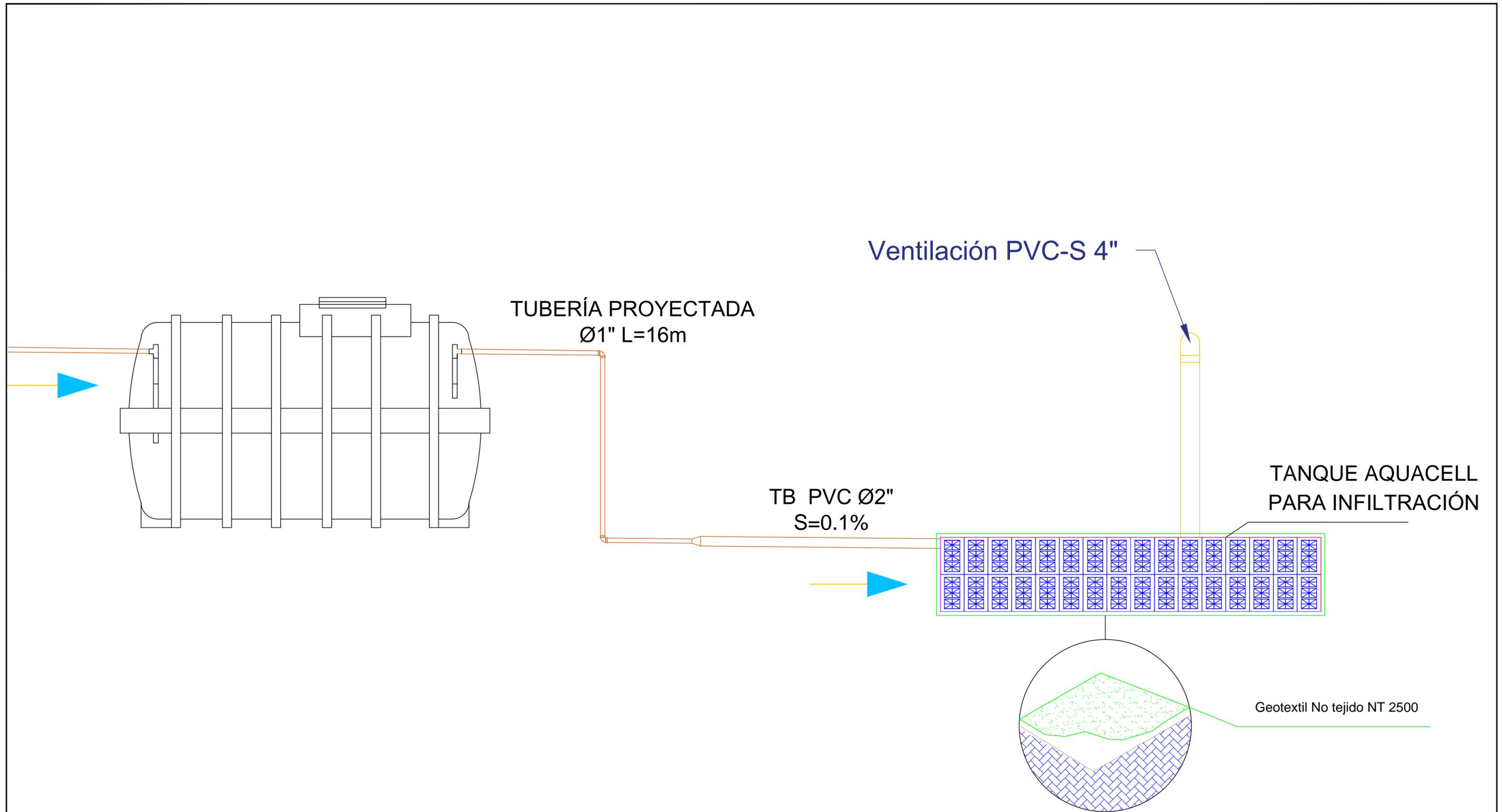
PERFIL TANQUE DE ALMACENAMIENTO AQUACELL-SIN ESCALA
