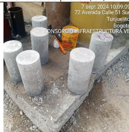
Cilindros de muestra para ensayos
