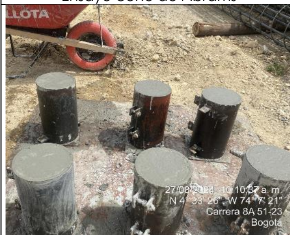
Concreto para ensayos
