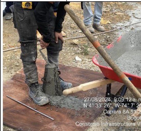
Ensayo cono de Abrams
