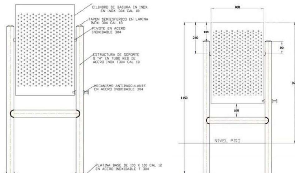
El material usado en la fabricación del cilindro debe ser en acero inoxidable AISI-304 cal 18 de tipo austenítico, con perforaciones equidistantes de diámetro 8 mm, mecanizadas en máquinas de control numérico computarizado CNC, para garantizar precisión en la ubicación de cada agujero.
