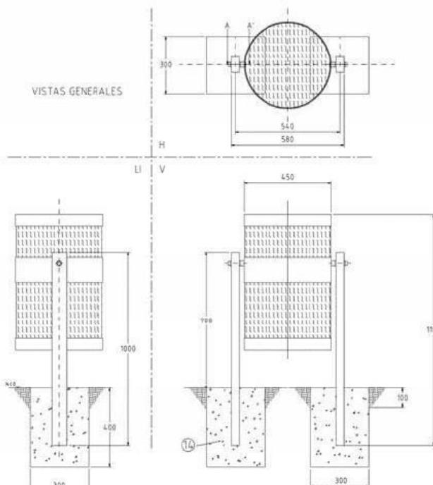
Elaborado por proceso mecánico de rolado y ajustado, para un diámetro de 450 mm, con altura efectiva de 700 mm. Se debe fabricar en malla de metal desplegado laminado en frío, para garantizar resistencia al impacto y al vandalismo. Se debe usar malla WD – 20 cal. 18, siempre y cuando cumpla con los requerimientos técnicos exigidos. El cilindro debe ser unido por proceso de soldadura de punto longitudinalmente, con puntos distanciados cada 20 mm.
