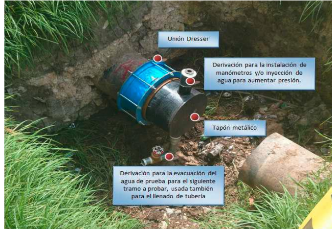
Figura 47. Esquema típico de Tapón de Prueba Hidráulica
