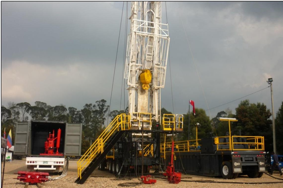
**Foto No.1. Ejemplo de equipo de perforación capacitado para la perforación y construcción del pozo a ubicar en el Municipio de Bojacá a una profundidad de 700.0 m.**
