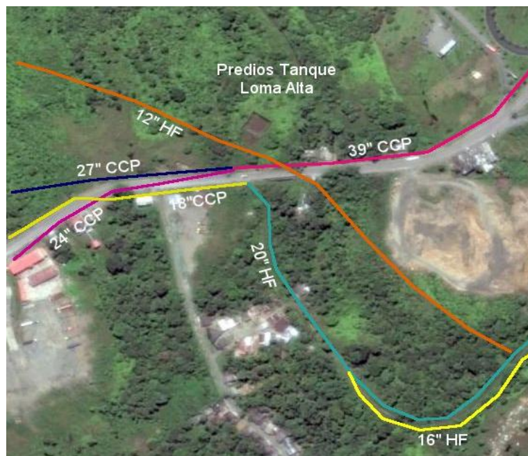
Figura 15. Tuberías Existentes en el Sector Km15.
