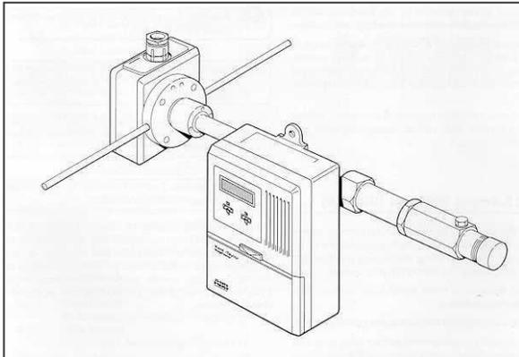
Los macromedidores de flujo por principio electromagnético de inserción son dispositivos electrónicos los cuales realizan mediciones en línea del caudal instantáneo y totalizado, proporcionando una indicación local sobre un display y una señal de corriente proporcional que puede ser incluida en cualquier sistema de control o automatización.
