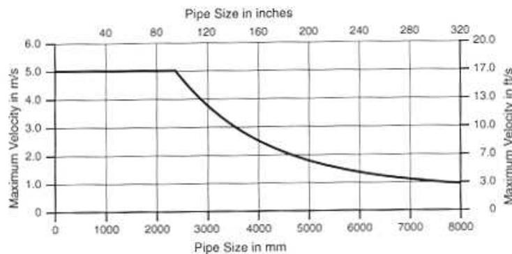
El rango de caudal para un diámetro específico resulta de la multiplicación de esta velocidad máxima con el diámetro interno de la tubería expresado en metros.
