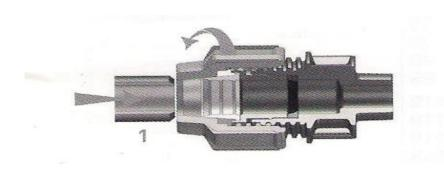
2. Marque la profundidad insertar la tubería en la tubería (véase el cuadro: la profundidad de inserción).
