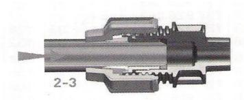
4. Acoplar el tubo a través del sello hasta que llegue a la parada de la instalación de tuberías. Compruebe la marca de la profundidad de inserción en la tubería para el montaje correcto.
