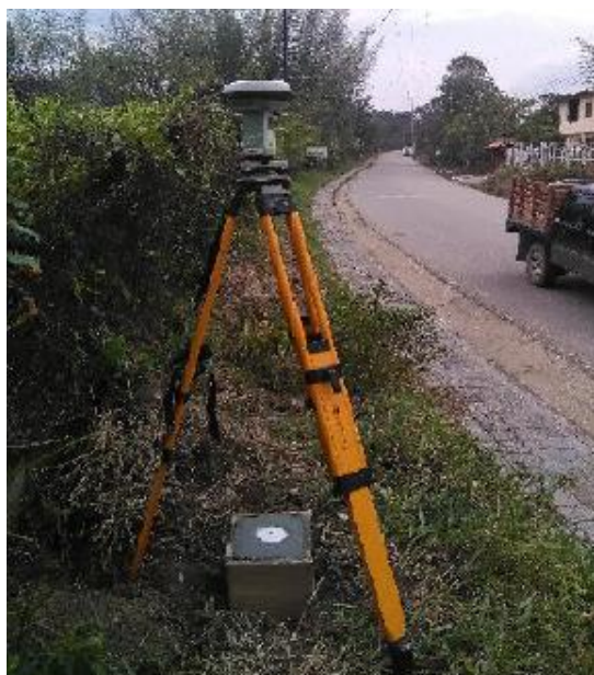
Figura 1 Equipo Posicionado sobre mojón.
