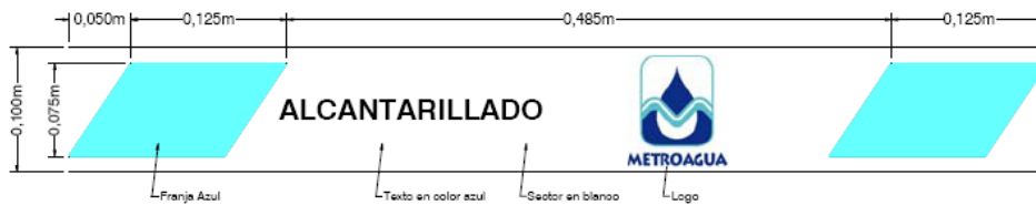
CINTA REFERENCIADORA ALCANTARILLADO
