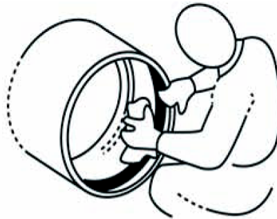
Figura 4-3: Lubricación de los empaques de sello
