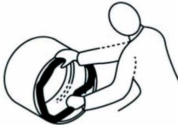
Figura 4-2: Instalación de los empaques de sello
