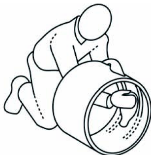
Figura 4-1: Limpieza del acople
