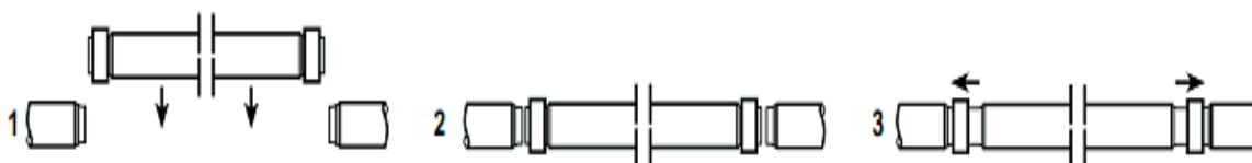
Figura 6-2: Montaje del tramo de cerramiento
