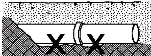
Figura 3-3: Apoyo incorrecto sobre el lecho de asiento
