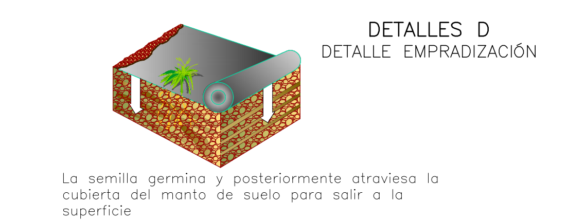
DETALLES D DETALLE EMPRADIZACION
