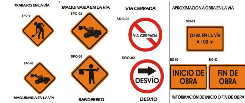
Figura 1-2 Señalización típica utilizada en las actividades de construcción de vías.
