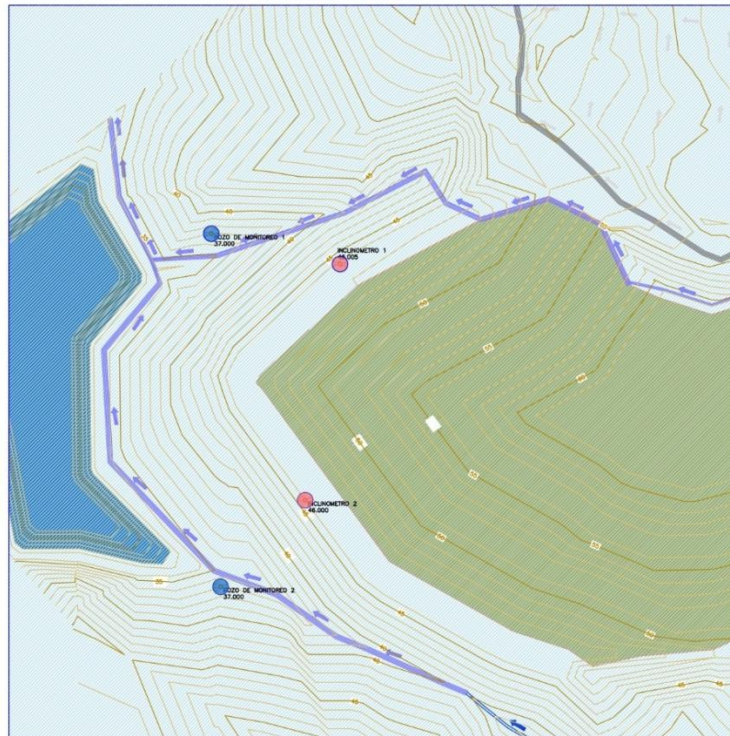
Figura 2.26 Ubicación instrumentación de monitoreo inclinómetros y pozos de monitoreo
