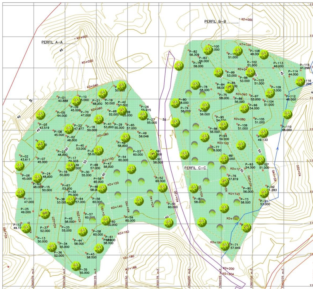
Figura 2.21 Diseño cierre técnico y clausura botadero actual
