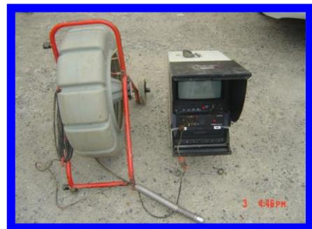
Se debe dejar registro en video de las inspecciones realizadas en los colectores y consolidar en un Informe Técnico el diagnóstico del tramo, de acuerdo con lo evidenciado con la cámara de video, incluyendo los registros fotográficos de cada inspección.
