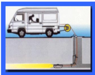
Proactiva con una sonda provista con cámara de video inspeccionará todos los tramos instalados para efectos de estudiar durante la inspección y posterior a ello las imágenes captadas, para detectar la ubicación de posibles daños, deflexiones de tubería, daños de empaques, obstrucciones, etc., cualquier fenómeno que pueda generar un mal funcionamiento de la red en operación y que pueden ser causal de rechazo por la Interventoría y deben ser corregidos por el contratista a su costo y riesgo.
