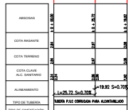
PERFIL 56 DEL POZO D-19 AL POZO D-16
