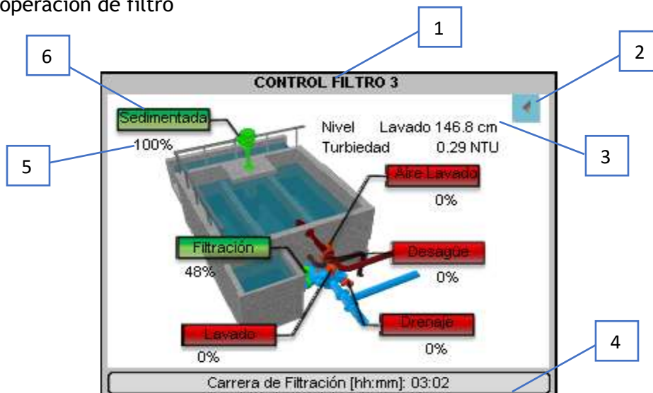
Panel de operación de filtros
