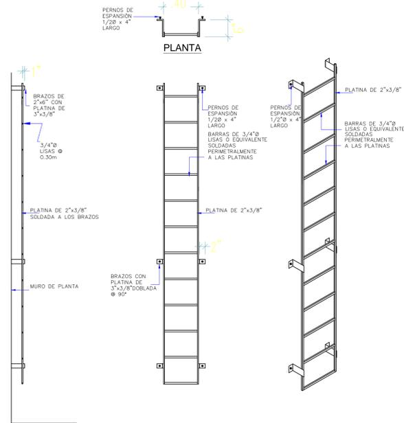
Nota: La escalera, pernos, anclajes y todos sus componentes serán de acero inoxidable. Opcional podrá utilizarse perfiles especiales pultruidos de plástico reforzado de fibra de vidrio (PRFV) resinas.
