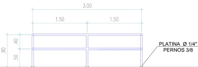
Nota: Los barandales serán de hierro galvanizado con perfiles redondos huecos de 50mm de diámetro nominal y 2mm de espesor. Opcional podrán utilizarse perfiles especiales pultruidos de plástico reforzado de fibra de vidrio (PRFV) resinas de 50mm de diámetro nominal y 4mm de espesor.
