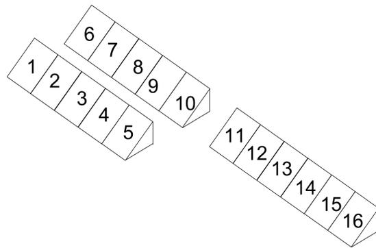
NOTA: LAS ESTRUCTURAS PARA PANELES SOLARES SE ORGANIZAN PARA GRUPOS DE 6 PANELES. PARA 16 PANELES, ESTA SERIA LA ORGANIZACION RECOMENDADA. SE DEBE DEJAR UN CALLEJON DE 1 m, PARA LA ACTIVADES DE MANTENIEMINTO Y CONEXIONADO. HAY QUE RECORDAR QUE LA ORIENTACION DE LOS PANELES DEBE SER NORTE-SUR CON UNA INCLINACION DE 15°.
