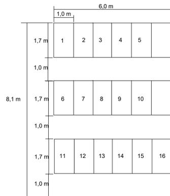
NOTA: LAS ESTRUCTURAS PARA PANELES SOLARES SE ORGANIZAN PARA GRUPOS DE 6 PANELES. PARA 16 PANELES, ESTA SERIA LA ORGANIZACION RECOMENDADA. SE DEBE DEJAR UN CALLEJON DE 1 m, PARA LA ACTIVADES DE MANTENIEMINTO Y CONEXIONADO. HAY QUE RECORDAR QUE LA ORIENTACION DE LOS PANELES DEBE SER NORTE-SUR CON UNA INCLINACION DE 15°
