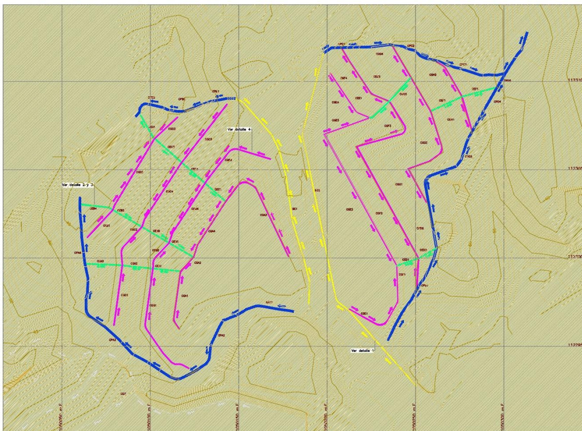
Figura 2.4 Diseño cunetas de manejo de aguas lluvias cierre técnico y clausura botadero a cielo abierto
