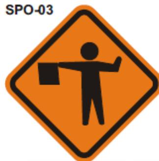
Esta señal se empleará para advertir a los conductores la aproximación a un tramo de vía que estará regulado por personal de la obra, el cual utilizará señales manuales.
