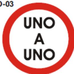
Se usará esta señal para reglamentar el paso alternado de los vehículos, cuando en una calzada de dos carriles se cierra uno de ellos.
