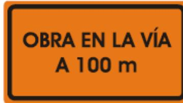
Esta señal se empleara para advertir conductores y peatones la aproximación a un tramo de vía afectado por una obra. La señal llevará la leyenda “OBRA EN LA VÍA”, seguida de la distancia a la cual se encuentra la obra. Se podrá usar conjuntamente con otras señales o repetirla variando la distancia.
