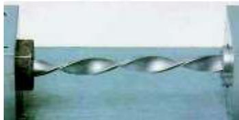
Deformación bajo carga exterior de un tubo de gran diámetro
