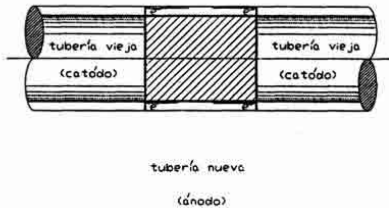
Figura 9.6 Corrosión por diferencias en el metal
