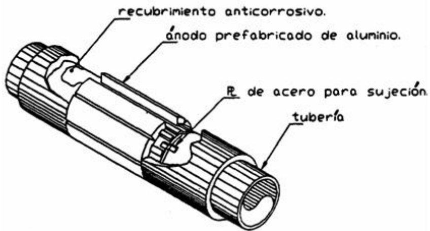
Figura 8.14 Detalles constructivos de ánodo
