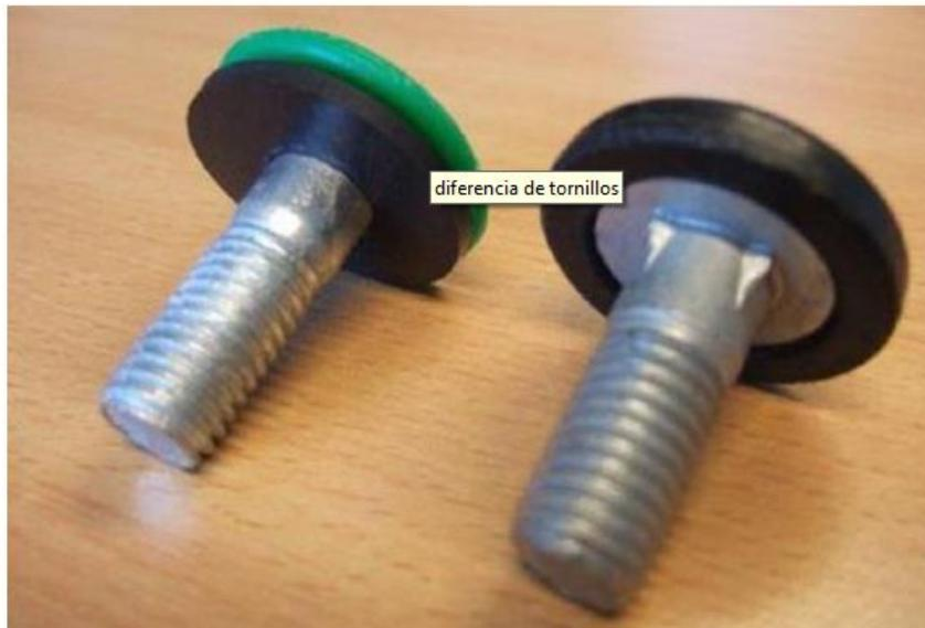
Solicitamos que sea únicamente aceptado el tornillo sin estrias, con el fin de no deteriorar el vidrio durante el ensamble del tanque.
