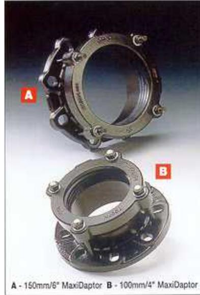
Es una brida universal diseñada para unir tubos de material y diámetros diferentes con brida del mismo o diferente diámetro nominal. Los Maxiadaptor permiten una desviación angular de 3º grados. Los rangos disponibles son 3",4",6",8",10" y 12".
