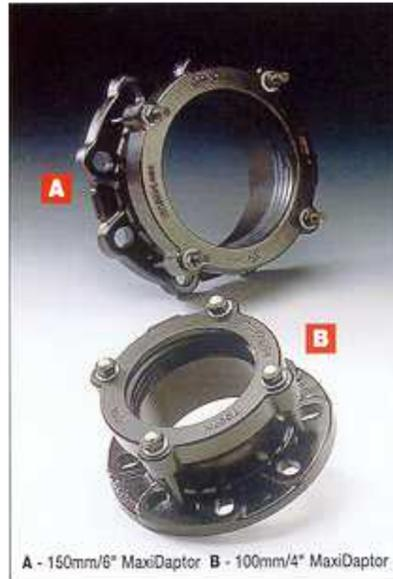
Es una brida universal diseñada para unir tubos de material y diámetros diferentes con brida del mismo o diferente diámetro nominal. Los Maxiadaptor permiten una desviación angular de 3° grados. Los rangos disponibles son 3",4",6",8",10" y 12".
