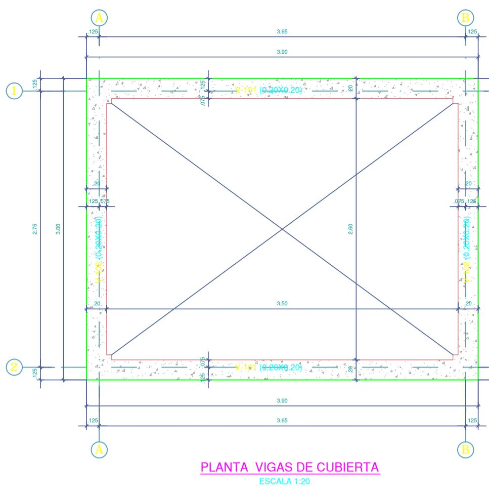
PLANTA VIGAS DE CUBIERTA
