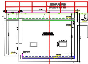
SEDIMENTADOR CORTE TRANSVERSAL ESC. 1:50
