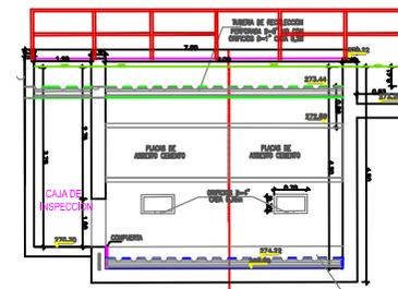
SEDIMENTADORES CORTE TRANSVERSAL ESC. 1:50
