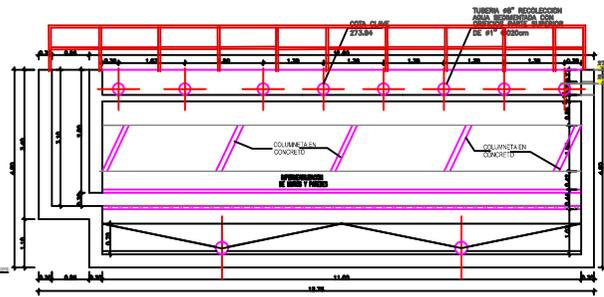
SEDIMENTADOR CORTE LONGITUDINAL ESC. 1:50
