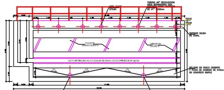
SEDIMENTADOR CORTE LONGITUDINAL ESC. 1:50
