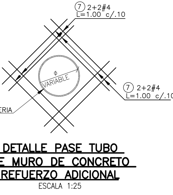
DETALLE TÍPICO PASE TUBO ESCALA 1:25
