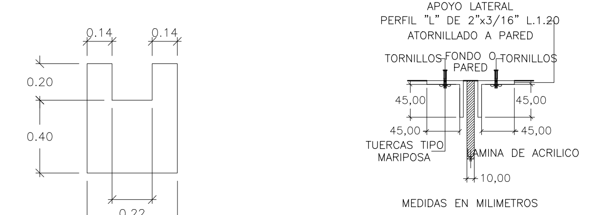
APOYO DE LAMINA DETALLE No 2 ESCALA 1 : 5
