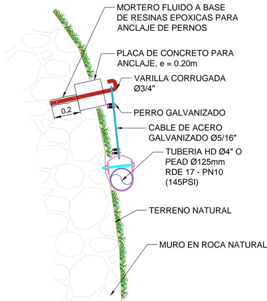
**PASO ELEVADO CON SISTEMA DE SUJECIÓN EN CABLE DE ACERO Y ABRAZADERAS**
