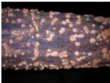
**Fotografía No. 6.** Depósitos sobre la superficie de los tubos de acero pintado expuestos en el interior del tanque. Enero 2003.3
