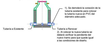
3) Se sellana con mortero fluido e impermeabilizado el perímetro de la tubería instalada
