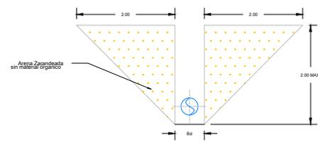
En caso de requerirse se podrá tender taludes 1:1 para efectuar la instalación de tuberías. Se deberá tener en cuenta lo siguiente:
