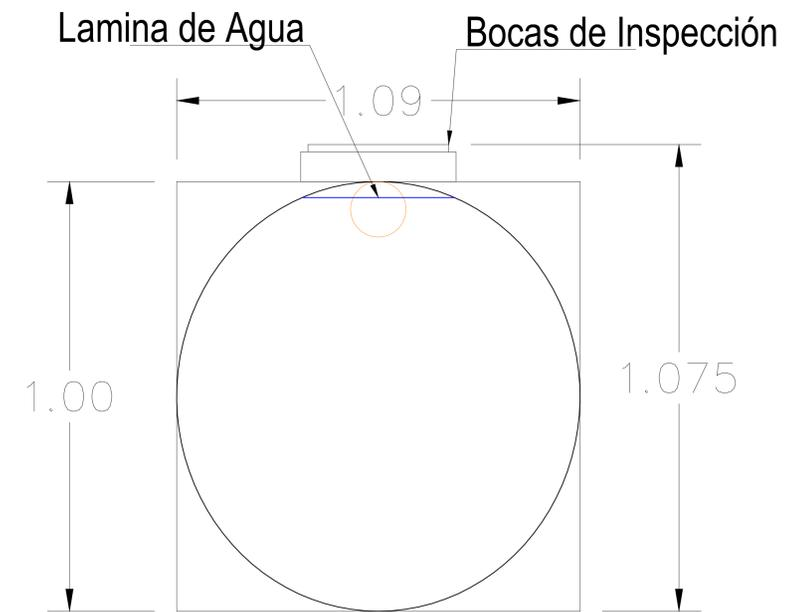
Corte B-B Sección Transversal (Tanque Séptico Entrada)
