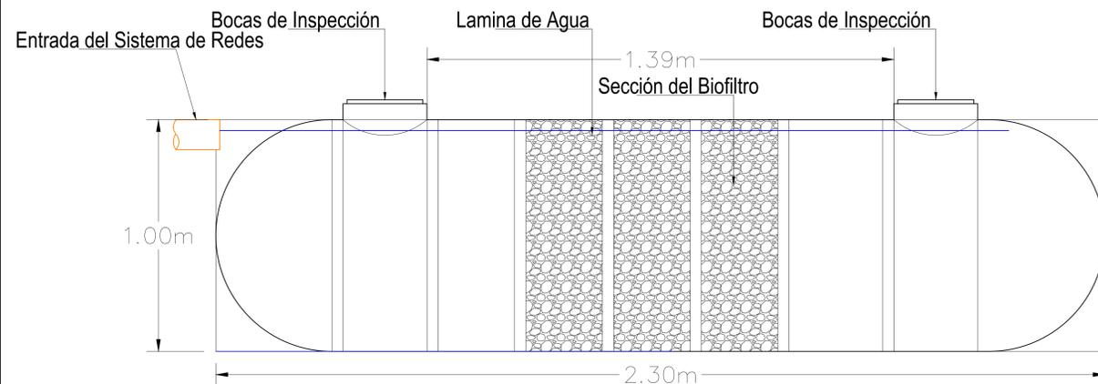
Corte A-A Perfil Hidráulico del Sistema (Tanque Séptico)
