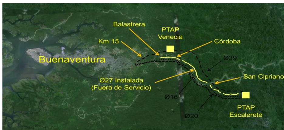
Figura 47. Localización General del Línea de 27" CCP Instalada desde PTAP Escalerete hasta el Sector Córdoba Fuente (Consultoría HIDROPACIFICO - IEH GRUCON)
