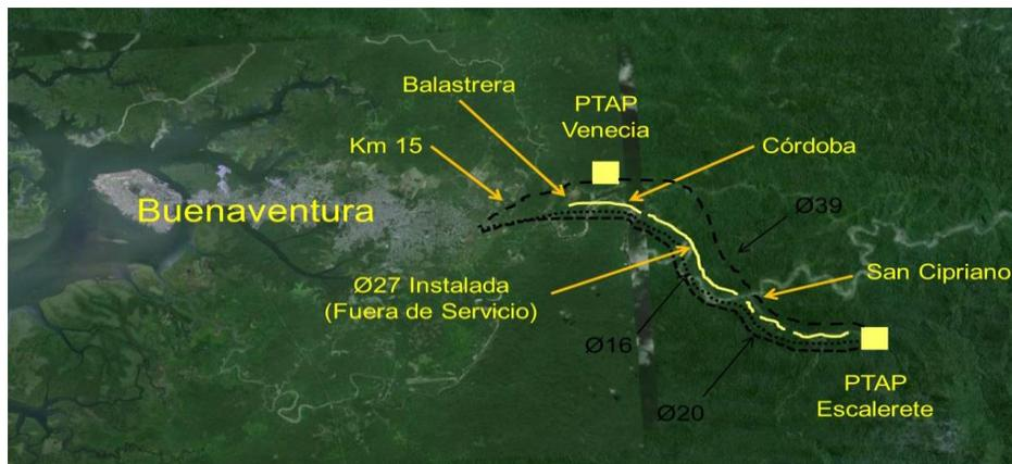
Figura 47. Localización General del Línea de 27" CCP Instalada desde PTAP Escalereite hasta el Sector Córdoba
