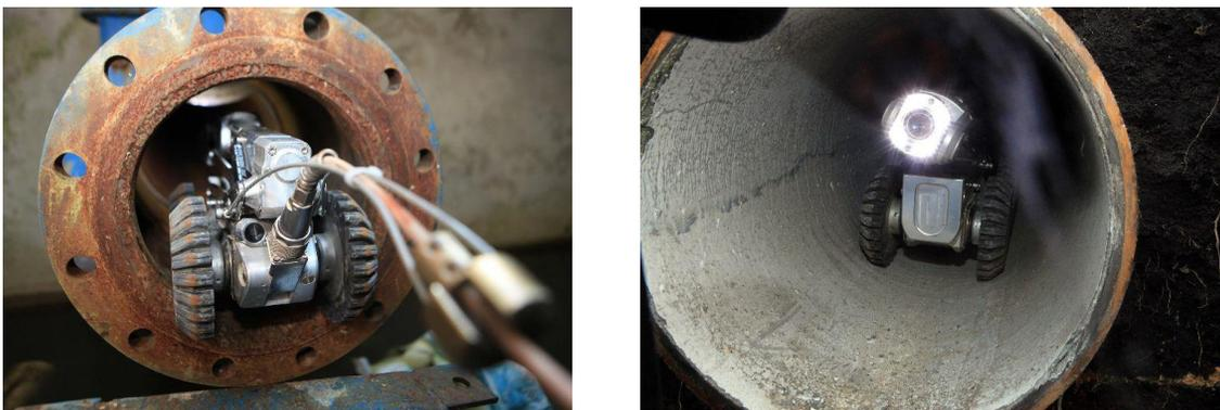
Figura 46. Equipo de Inspección Visual Interna (fuente: EPC)
