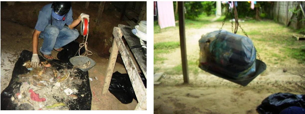
Foto 2. Pesaje de los residuos para determinar la composición física porcentual.
