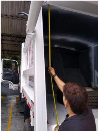
Revisión de altura de compactador y revisión de accionamiento de sistemas
