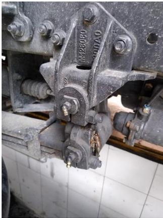
Muelles delanteros y traseros con graseras instaladas y con grasa evidente ( Buen estado)
