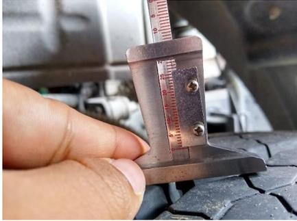
Profundidad de llantas , Pos 1: 14 mm , Pos 2: 14 mm, Pchas posiciones 3 y 4 : 13 mm, Pchas posiciones 5 y 6 : 13 mm (Buen estado)
