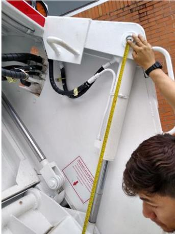
Revisión de medidas de cilindros Hidráulicos
