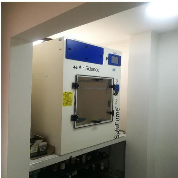
FOTOGRAFIA 7 En esta fotografía se observa la cámara de cianocrilato para revelado de huellas latentes, en este momento el equipo se encuentra en funcionamiento y tiene mantenimiento preventivo pero falta el dactiloscopista
