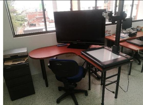
FOTOGRAFIA 9 Se observa el puesto designado para fotografía y video el cual cuenta con un monitor, estativo fotográfico e integrado de video para análisis de imágenes.
