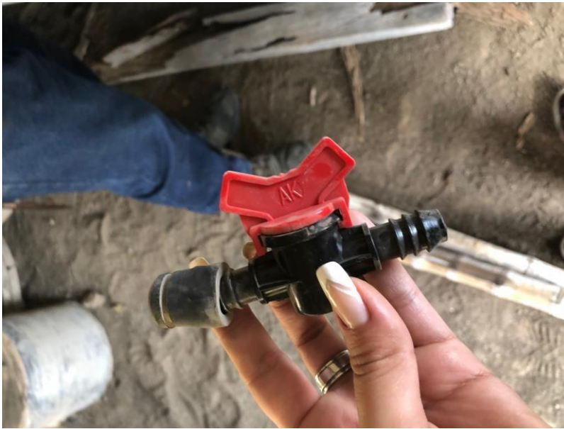
Válvulas reguladoras del goteo y distribución del sistema
