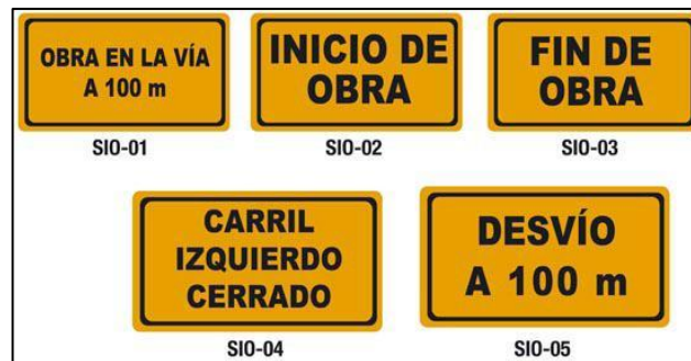
Señales Informativas en Obra
