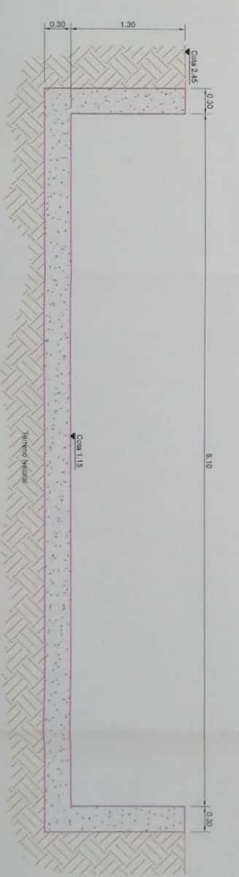
CORTE C - C MAXIMA SECCION CANAL DE TRANSICION DESDE TUBO GRP Ø=2000 mm, A BOX CULVERT EN CRUCE CON VIA CIRCUNVALAR Escala 1:25
