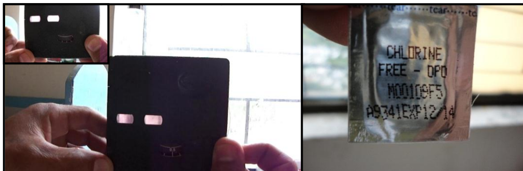
Figura 31. Comparador Visual de Cloro y Reactivo
