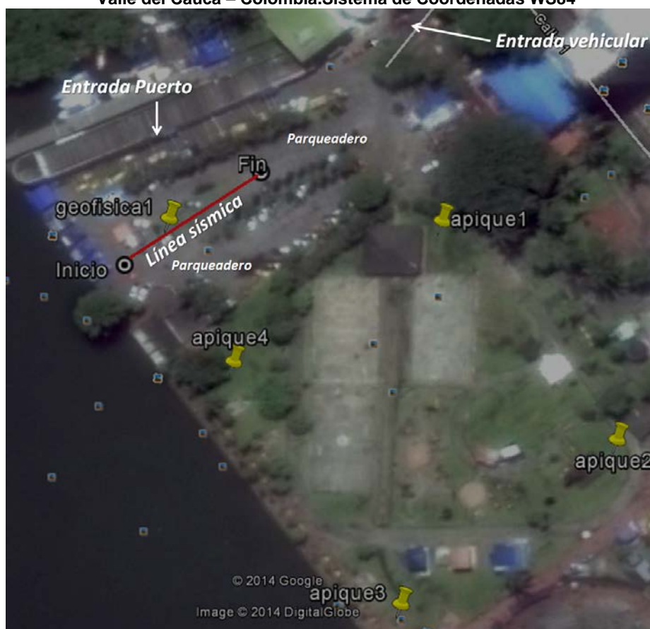
Figura 2. Detalle de la línea sísmica para la realización de Re.Mi., en el Puerto de Buenaventura, Valle del Cauca – Colombia. Figura modificada de Google Earth.
