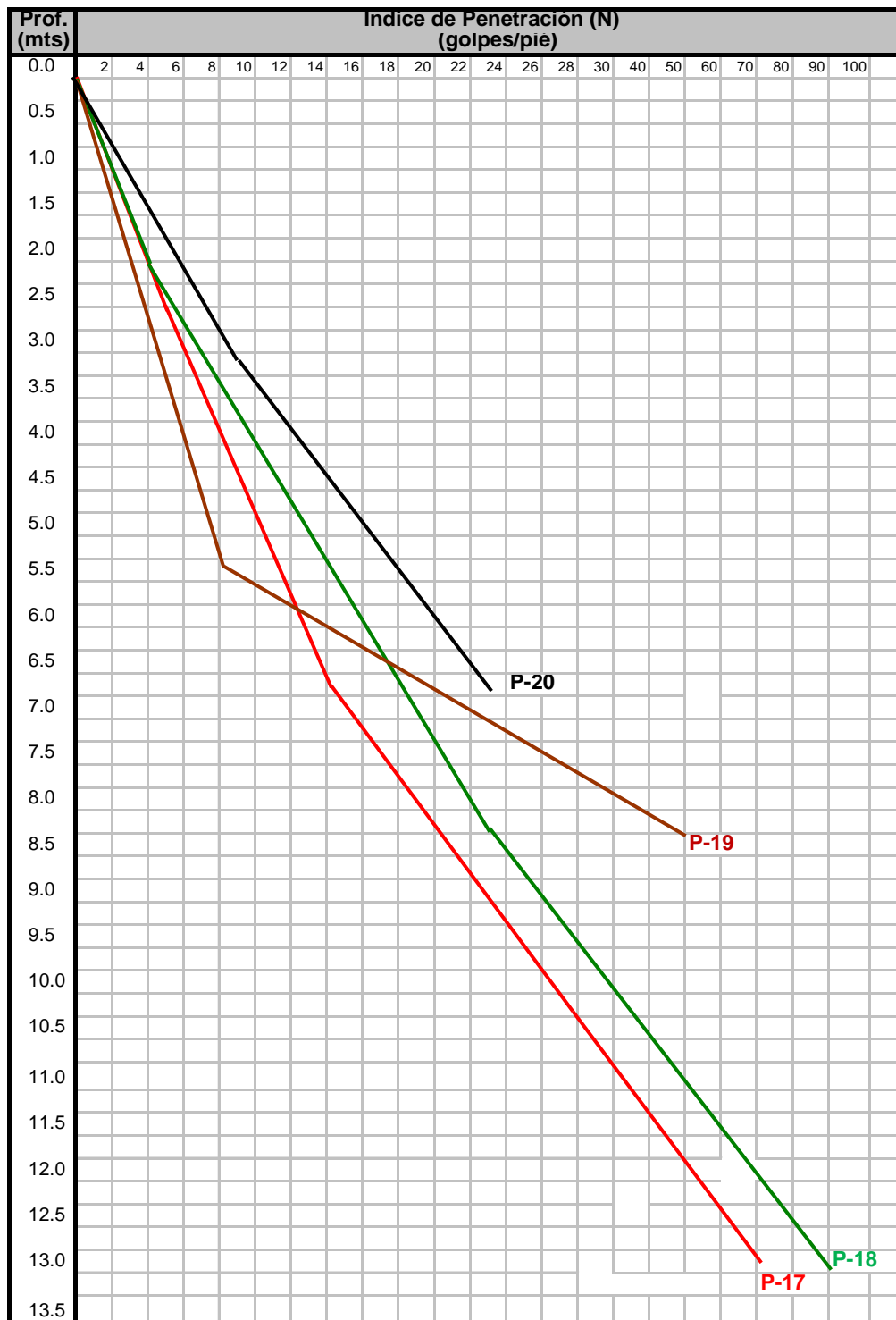
CUADRO No. 2.5 Ensayo de Penetración Estándar vs Profundidad (P- 17 a P-20)
