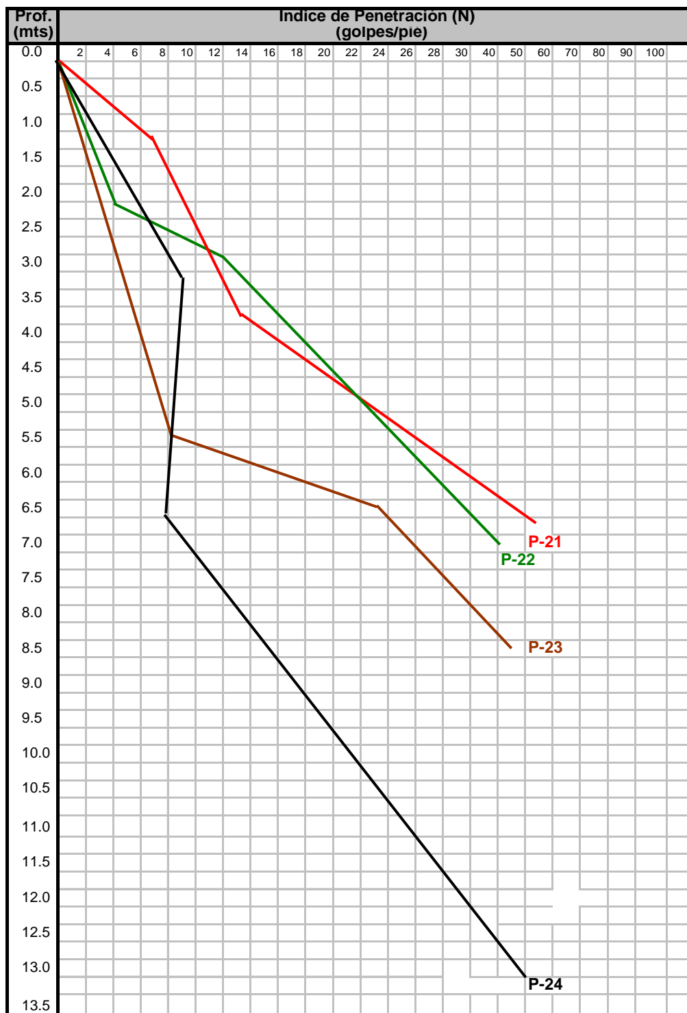
CUADRO No. 2.6 Ensayo de Penetración Estándar vs Profundidad (P- 21 a P-24)
