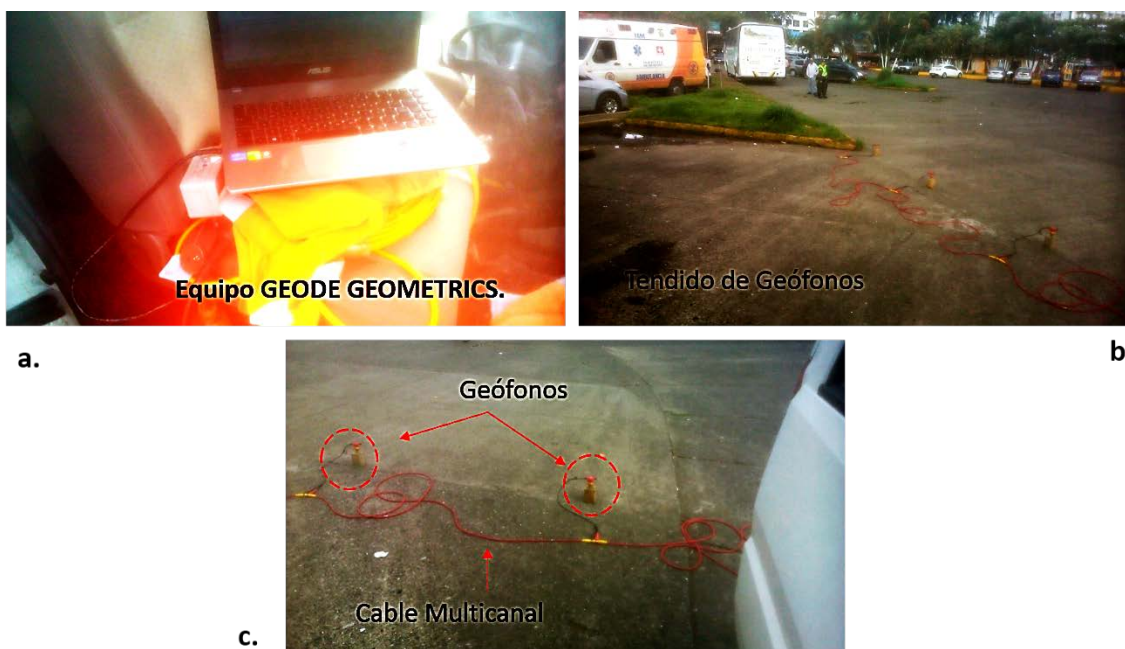
Figura 6 . a). Sismógrafo Geode-Geometrics NZ 24CH, b y c) disposición de geófonos y línea sísmica en el levantamiento de sísmica Microtrémores, Buenaventura, Valle del Cauca - Colombia. La policía Nacional Facilitó dos agentes para la ayuda en la adquisición y seguridad de los equipos.
